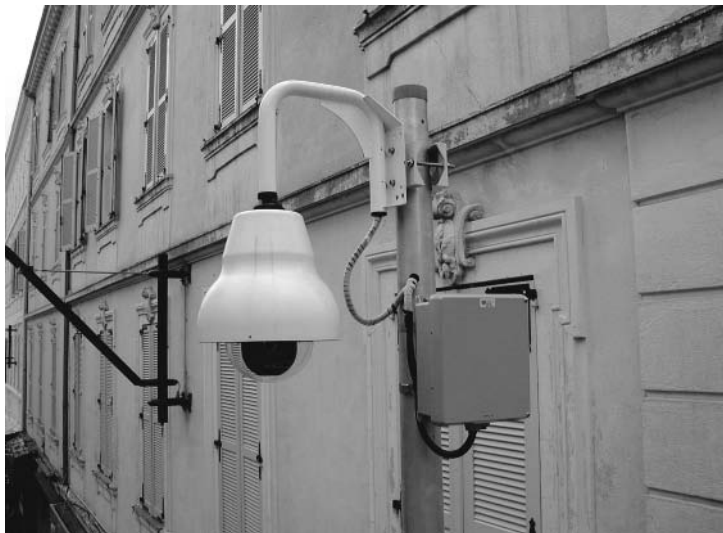
Figure 5.9 – Caméra dôme motorisée.
