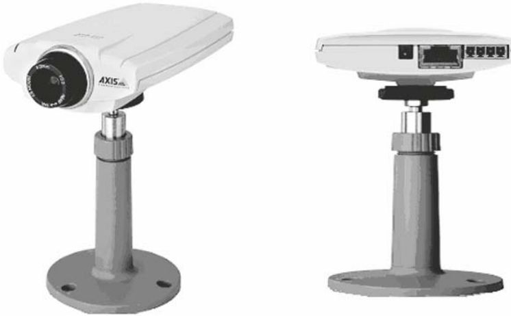
Figure 5.4 – Caméras IP (d'après documentation Axis).
